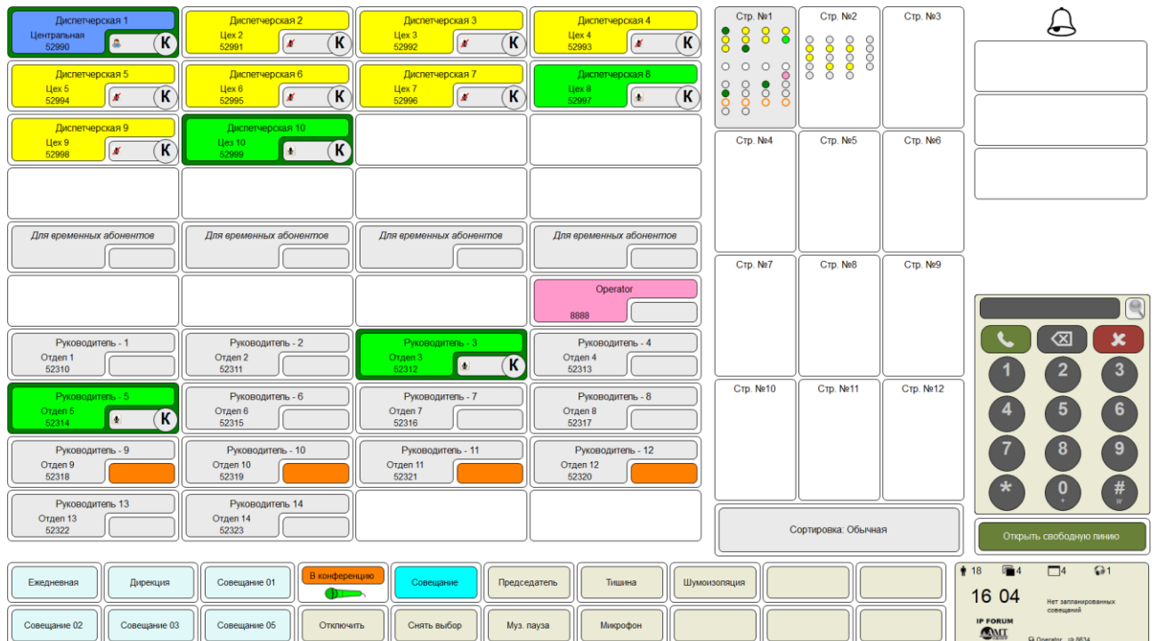
Рисунок 2 – Раскладка кнопочного поля пульта типа SMALL (редакция СЕ)
